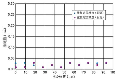
0↔80μm重复定位误差小于50nm
